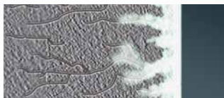
Kristālisko struktūru iekļūšana betonā, kapilāru gaismas noslēgšana.
